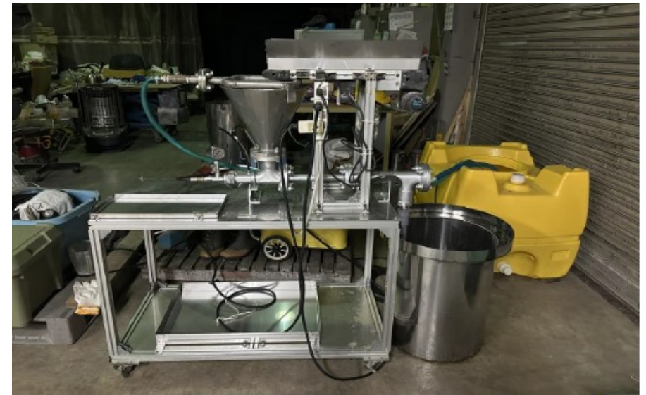
東京電力グループ(JESCO)・三和製作所による 高圧エジェクターによる土壌の解砕分級実証試験
