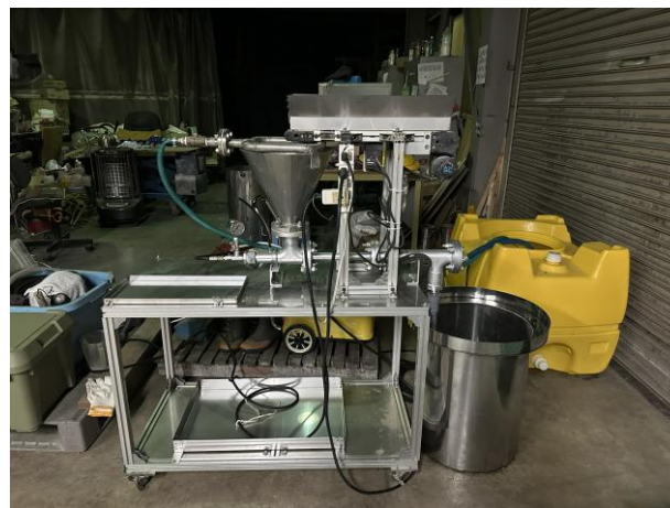
（当社開発の「土壌汚染洗浄装置」）
